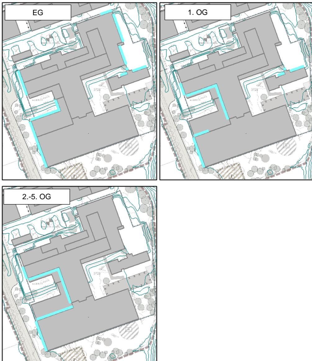
Abbildung 23. Fassaden mit Überschreitung des Immissionsrichtwerts der TA Lärm für Pflegeanstalten durch Gewerbegeräusche.
