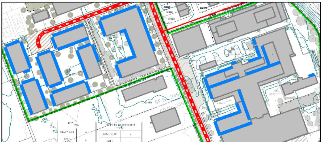
Abbildung 20. Fassaden mit Verkehrsgeräusch-Beurteilungspegeln  $> 45$  dB(A) nachts, lautestes Stockwerk.
