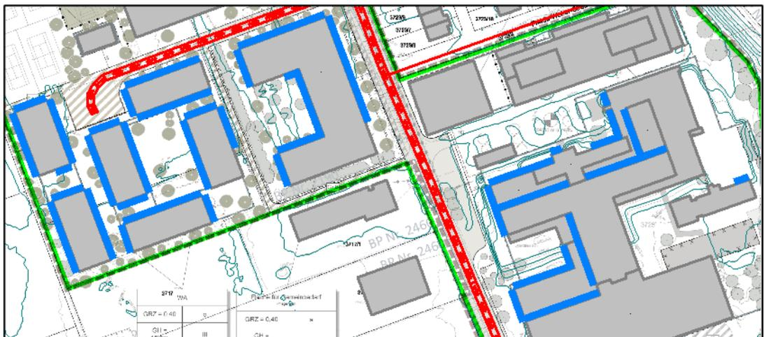
Abbildung A. Fassaden mit Anforderungen zu Schallschutzmaßnahmen (schallgedämmte Lüftungseinrichtungen) bzgl. der Verkehrsgeräusche.
