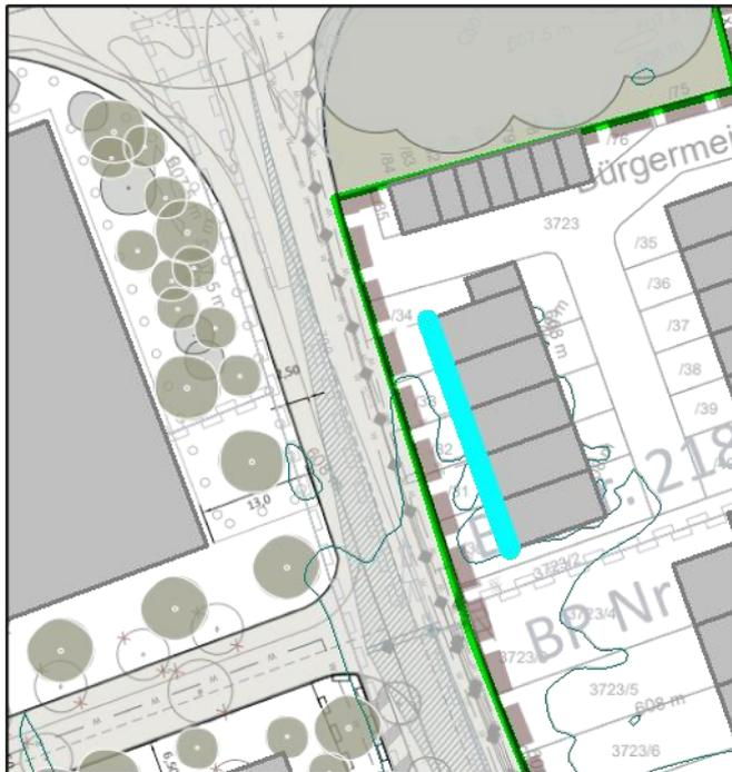
Abbildung 21. Fassaden mit Erhöhung der Verkehrsgeräuschbelastung um mindestens 3 dB.
