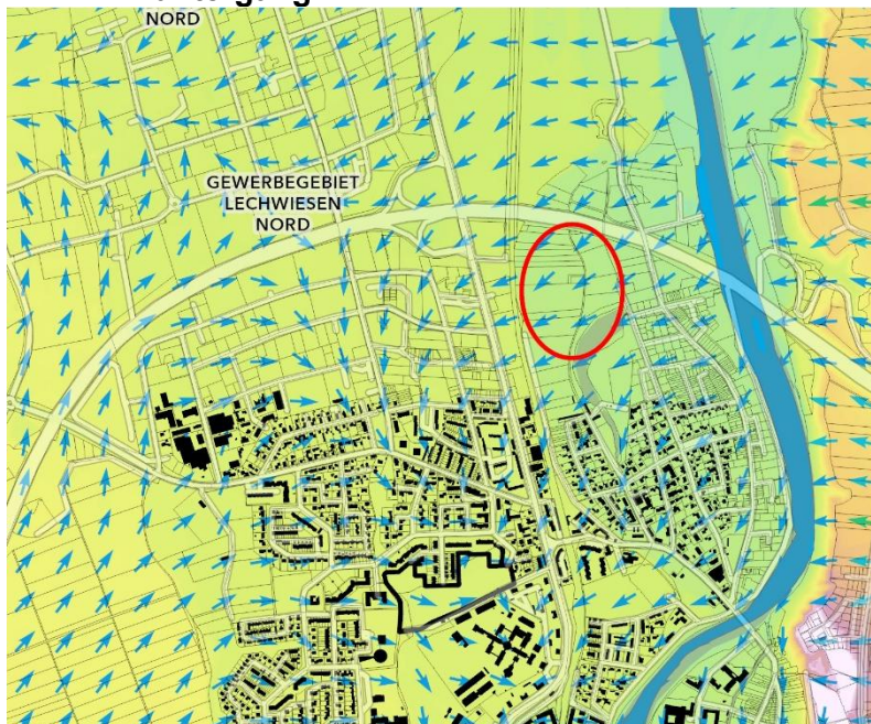
Abb. 26: Kaltluftproduktion und Kaltluftströmung - nach 4 Stunden nach Sonnenuntergang
