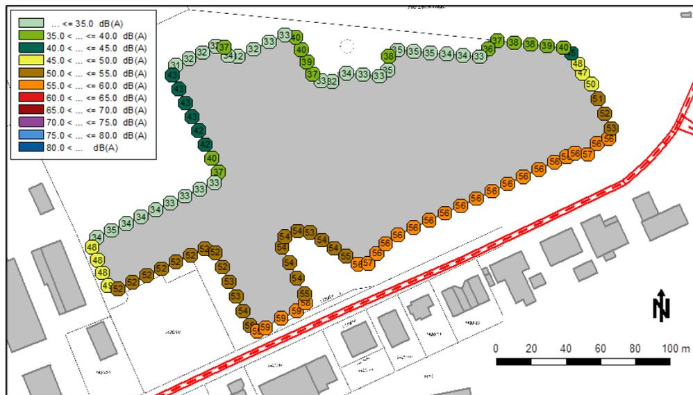
Abbildung 5. Verkehrsgeräuschimmissionen im Plangebiet. Gebäudelärmkarte für die Baugrenzen. Lautestes Stockwerk. Tageszeitraum 06:00 bis 22:00 Uhr.
